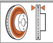
É necessário substituir os discos quando as pistas de frenagem apresentam riscos profundos e a sua espessura é inferior ao valor indicado (Min. Th.).
