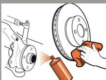
Eliminar a camada de óleo e de massa das superfícies de acoplamento e das superfícies de frenagem, para não reduzir a eficácia das pastilhas de freio. Aplicar uma camada de óleo anticorrosão na superfície do cubo, de maneira a formar uma película protetora uniforme.
