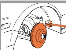
Centrar o disco de freio, apertando uniformemente pelo método em cruz. Controlar a flutuação do disco com auxilio de um comparador. O valor lido no comparador deve ser inferior a 0,09 mm. Esta operação é muito importante, porque qualquer oscilação do disco pode provocar um desgaste irregular das pistas de frenagem, bem como vibrações durante a frenagem.
