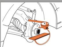
Com auxilio de um comparador, verificar a planidade da flange do cubo (tolerância inferior a 0,03 mm). Com uma régua de precisão, verificar a planidade. Se as superfícies não forem planas, o disco apresentará um desequilíbrio igual a duas vezes o valor obtido no cubo.
