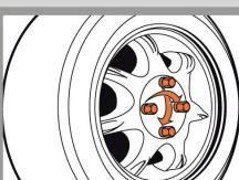
Montar as rodas depois de as equilibrado corretamente e apertar a fundo com uma chave dinamométrica, uniformemente e utilizando o método em cruz, ao binário previsto (ver tabela).
