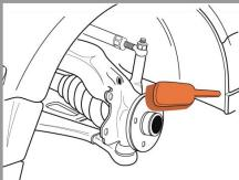
Eliminar as impurezas e a ferrugem presentes no plano de apoio do cubo e assegurar-se de que o piano não está deformado ou danificado.
