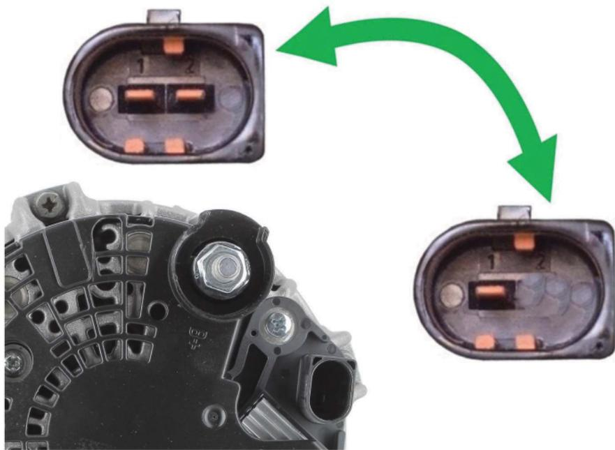
L'alternateur démonté possède un connecteur avec un nombre de broches différent.
