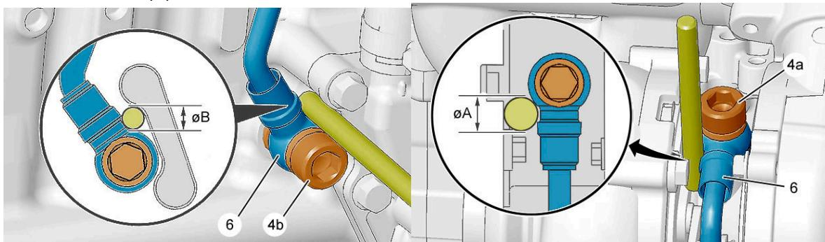
*Fiti foarte atenti la asamblarea corecta exact ca in ilustratie (D), astfel incat teava trebuie sa fie pozitionata pe centrul axial al conexiunii (E & F)*
