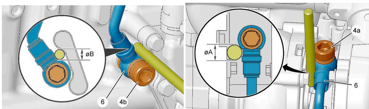
*Le montage doit impérativement être effectué comme le montre l'illustration (D) ci-dessous. Le tuyau doit obligatoirement être centré sur l'axe (E - F)*
