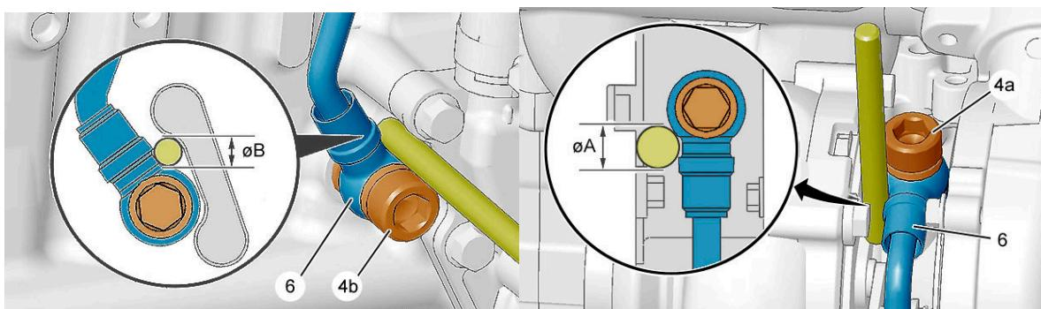
Zwróć szczególną uwagę na poprawny montaż tak jak na obrazku (D), przewód musi przechodzić dokładnie przez środek przekroju połączenia.
