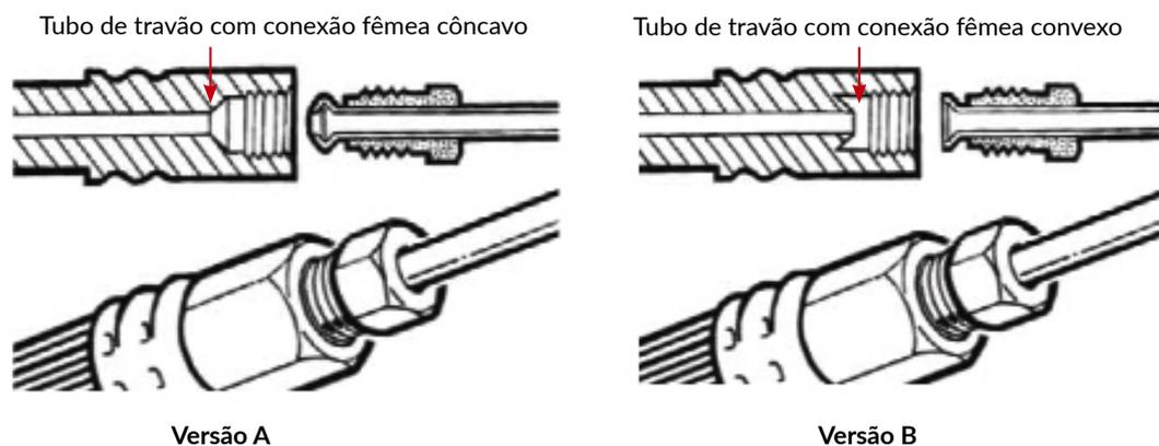
**Versão A** - Tubo com conexão fêmea com bicone côncavo para fazer ligação com um macho convexo
