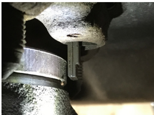
Fig. 2 Disco de travão e sensor corretamente instalados
