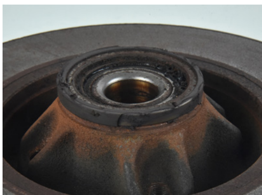
Fig. 1 Anel de ABS danificado devido ao contacto com o sensor
