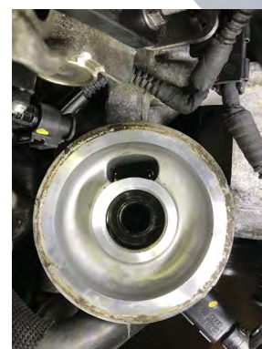
Ventiel correct geïnstalleerd
