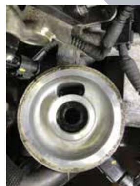
Korrekt installiertes Ventil
