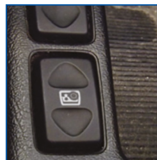
L'interruttore comando cristallo si trova nella consolle centrale vicino alla leva del freno a mano.
