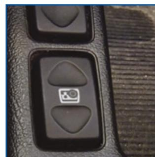
Der Heckscheibenschalter befindet sich in der Zentralkonsole in der Nähe der Handbremse.
