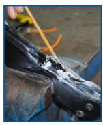
Per la protezione contro la corrosione è necessario coprire il metallo esposto. Applicare uno strato di primer sul metallo. Poi, una volta asciutto, applicare uno strato di vernice a base d'olio.
