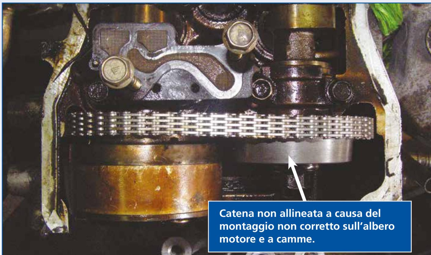
Catena non allineata a causa del montaggio non corretto sull'albero motore e a camme.
