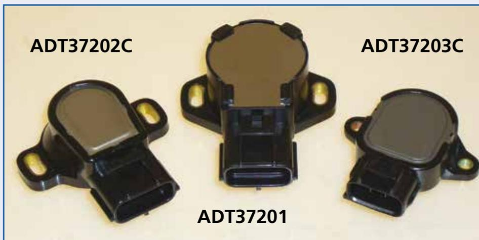
Tale dispositivo comunica alla centralina ECU del motore l'esatta posizione della valvola a farfalla, in qualsiasi momento, tramite la variazione della tensione in uscita attraverso un resistore variabile o potenziometro. Si tratta di un componente chiave del sistema di gestione del motore: se è difettoso o si guasta può provocare i seguenti sintomi.
