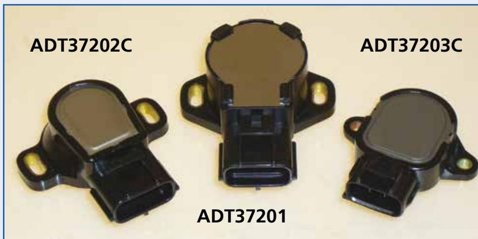
Ce dispositif indique à tout moment la position exacte du papillon des gaz à l'ECU du moteur en faisant varier la tension de sortie à l'aide d'une résistance variable ou d'un potentiomètre. Il s'agit d'un composant clé du système de gestion du moteur du véhicule et si un dysfonctionnement peut entraîner des symptômes tels que;
