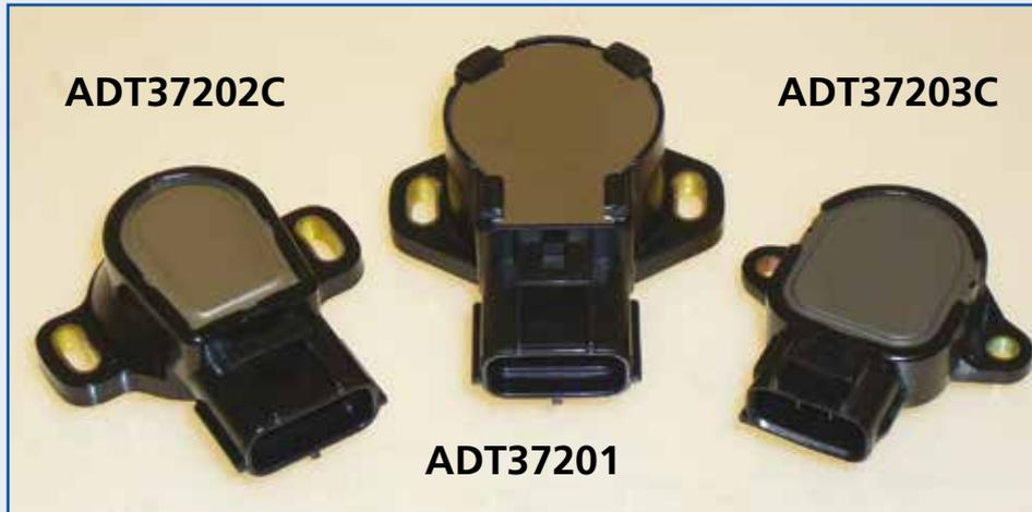
Este dispositivo señala la posición exacta de la válvula del acelerador en cualquier momento a la ECU del motor modificando la tensión de salida mediante una resistencia variable o potenciómetro. Es un componente clave en el sistema de gestión del motor del vehículo y su mal funcionamiento puede provocar síntomas tales como;
