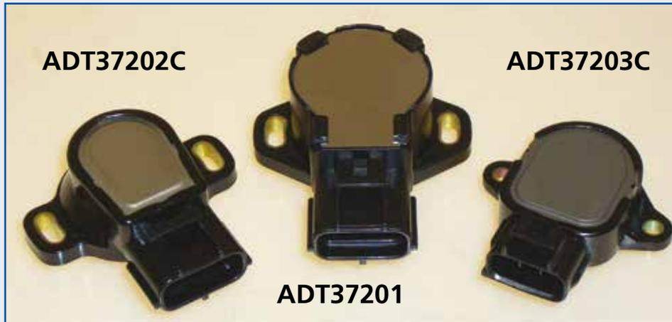
Der Drosselklappen-Stellungssensor (Potentiometer) meldet zu jeder Zeit die genaue Stellung der Drosselklappe an das Motorsteuergerät (ECU), indem er die Ausgangsspannung durch einen verstellbaren Widerstand, bzw. ein Potentiometer verändert. Es handelt sich um eine wichtige Komponente der Motorsteuerung, die im Störfall folgende Symptome hervorrufen kann:
