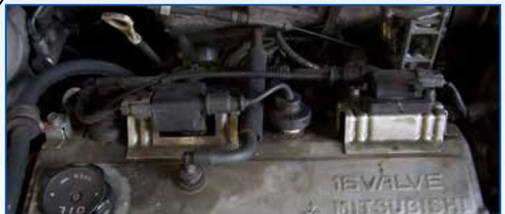
Blue Print recomienda encarecidamente que se sustituyan las bujías de encendido y los cables de alta tensión además del conjunto de bobina, o que se comprueben cuidadosamente. También recomendamos que antes de sustituir la o las bobinas de encendido, se siga un procedimiento de diagnóstico lógico para evitar una sustitución innecesaria.
