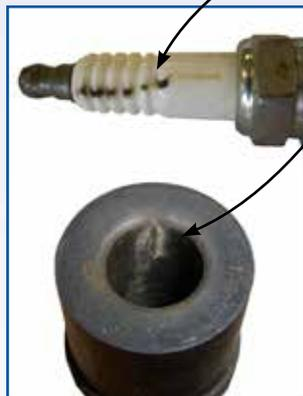
**El ejemplo B** muestra dónde ha habido fuga de la chispa a lo largo de la cerámica de la bujía de encendido (ver marcas de quemado).
