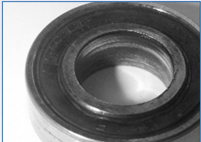
*Ilustración que muestra el desgaste entre el eje principal de transmisión y el interior de la pista de rodadura interior, debido al agarrotamiento del cojinete*
