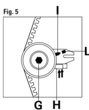
FIGURA 5 Aflojar el tornillo de fijación G y empujar sobre el punto indicado H, llevar el indicador móvil I hasta la posición de máxima tensión, y luego de hacer coincidir los puntos I y L, apretar el tornillo de fijación G.
