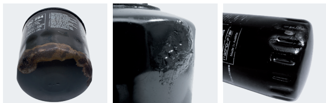
Εικόνα 3: Μπορεί να προκληθεί ζημιά από διάβρωση στο βιδωτό φίλτρο.
