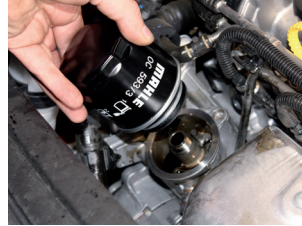
Resim 2: Yeni filtre el ile sıkılır.
