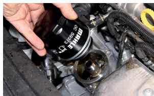
Иллюстрация 2: Затяжка нового фильтра выполняется вручную.
