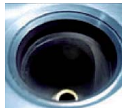
Bild 6: Das optimale Montageergebnis mit erneuertem Ventilsitzring.
