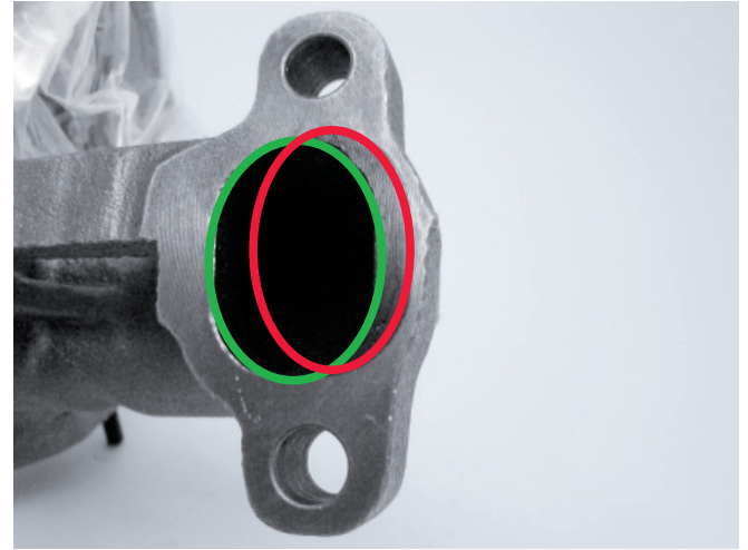
Őekil2: mek 030TC15116000: kırmızı elips: yanlış pozisyon, yeřil elips: doęru pozisyon
