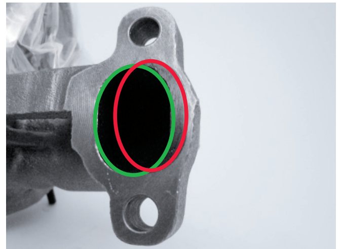
Abbildung 2: Beispiel 030TC15116000: Rote Ellipse: falsche Position, Grüne Ellipse: richtige Position
