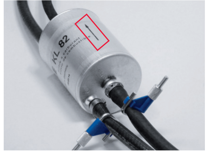
Resim 2: Yakıt hatlarının boşalmasını önlemek için bağlantıların kesilmesi
