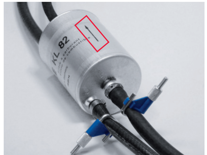
Figura 2: Desacoplamiento de conexiones para evitar que se vacíen las tuberías de combustible
