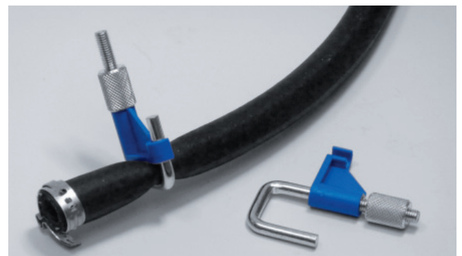
Photo 1 : colliers de serrage
