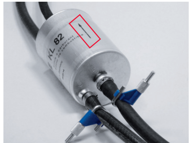
Photo 2 : bloquez les conduites de carburant afin d'éviter qu'elles ne se vident
