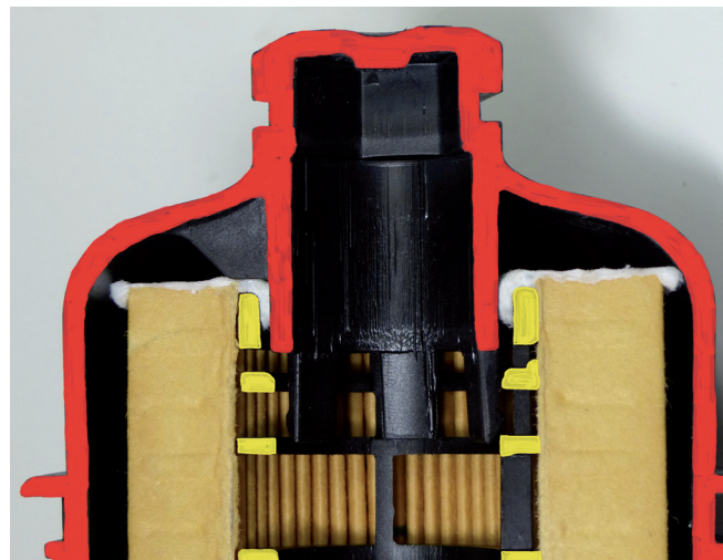
Изображение 2: При монтаже нетканый материал (белого цвета) запрессовывается между внутренней обечайкой (желтого цвета) и стояком (красного цвета), образуя надежную прокладку по всей поверхности.
