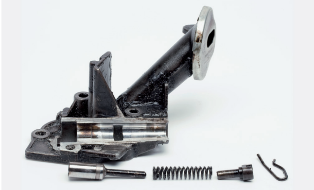
Resim 1: Açılmış yağ pompası, entegre ayar supabı ile birlikte
