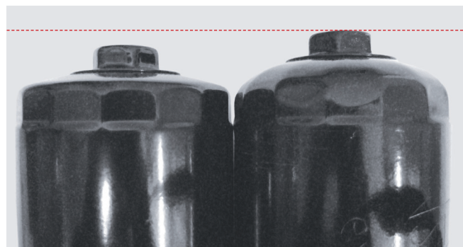
Figura 3: Comparación directa entre filtros de aceite; a la izquierda, en estado normal; a la derecha, deformado
