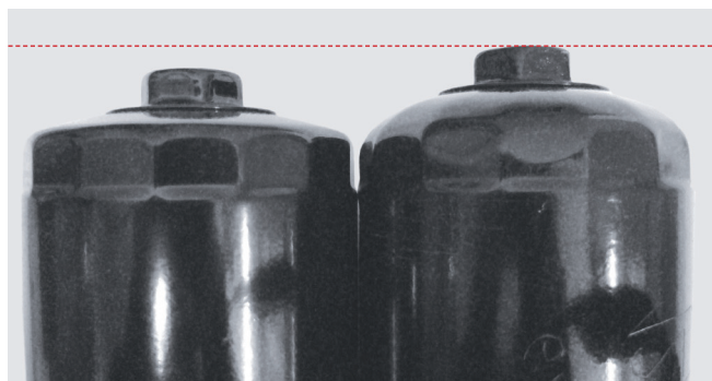
Рисунок 3: Нормальный масляный фильтр (слева) и деформированный масляный фильтр (справа)
