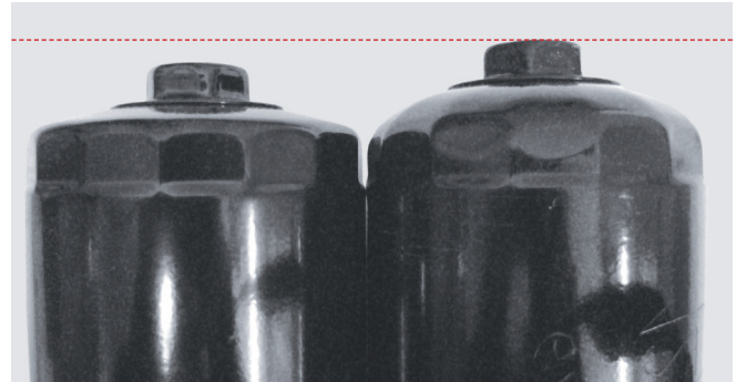
Resim 3: Yağ filtrelerinin direkt kıyaslaması - Solda: Normal koşullar altında, sağda: Deforme olmuş
