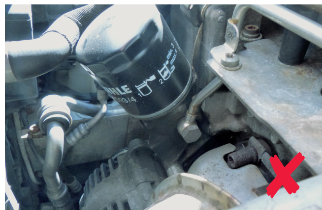
Рисунок 3: В зависимости от места монтажа при замене масляного фильтра важно защитить генератор от попадания масла.
