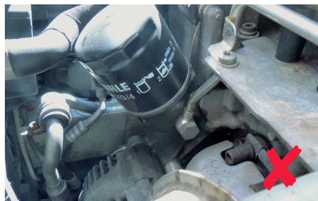
Figura 3: Según la posición de montaje, es importante proteger el alternador contra la entrada de aceite al cambiar el filtro.
