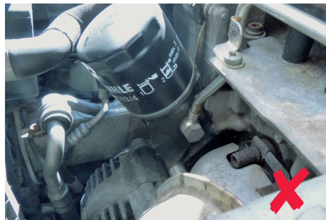
Ilustracja 3: W zależności od konstrukcji należy chronić alternator przed przedostaniem się oleju podczas wymiany oleju.
