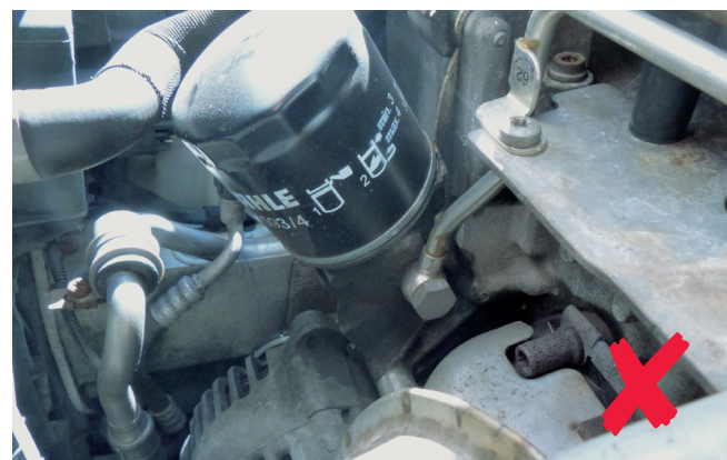
Figure 3 : Selon la position d'installation, il est nécessaire de protéger l'alternateur lors du changement de filtre avant le remplissage d'huile.
