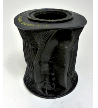
Resim 3: Aşırı ısınma nedeniyle deforme olan/yırtılan yağ filtresi elemanı
