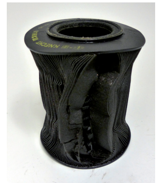
Εικόνα 3: Παραμορφωμένο/σχισμένο λόγω υπερθέρμανσης στοιχείο φίλτρου λαδιού
