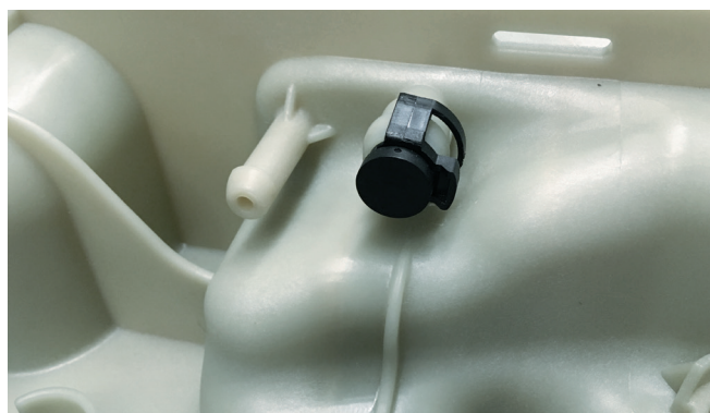
Figure 3 : Pour les véhicules Euro 4 et 5, un obturateur doit être placé sur le raccordement.
