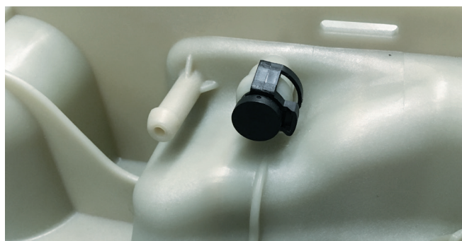
Рисунок 3: В автомобилях, соответствующих стандартам Евро-4 и Евро-5, разъем должен быть перекрыт заглушкой
