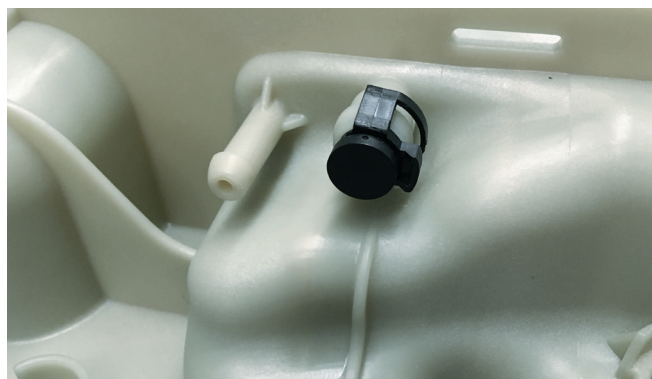
Εικόνα 3: Για οχήματα τεχνολογίας EURO 4 και 5, η σύνδεση πρέπει να σφραγιστεί με ένα πώμα στεγάνωσης
