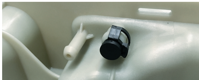
Abbildung 3: Bei EURO 4 und 5 muss der Anschluss mit einem Blindstopfen verschlossen werden
