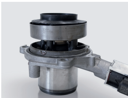
Εικόνα 1: Ρυθμιζόμενη αντλία ψυκτικού υγρού με σταθερό συρόμενο έλασμα (καθόλου κυκλοφορία)
