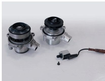
Εικόνα 2: Ο ενεργοποιητής της ρυθμισμένης αντλίας πρέπει να αφαιρεθεί και να τοποθετηθεί στη νέα αντλία
