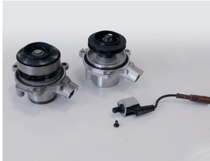
Resim 2: Kontrollü pompanın aktüatörü sökülmesi ve yeni pompaya takılması
