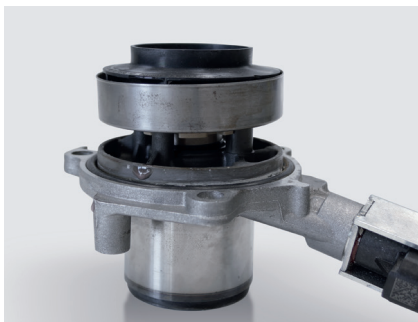
Figura 1: Bomba de refrigerante regulada con panel deslizante fijo (sin circulación)
