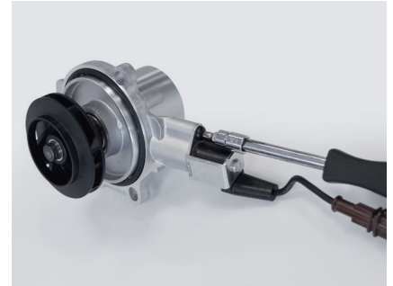
Resim 3: Yeni, yer değiştirilmiş aktüatörlü kontrolsüz soğutma sıvısı pompası
