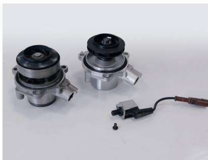
Zdjęcie 2: Element sterujący regulowanej pompy należy wymontować i zamontować w nowej pompie
