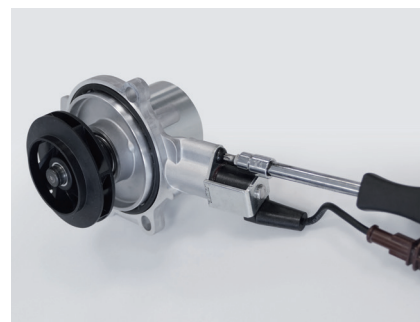
Рисунок 3: Новый нерегулируемый насос охлаждающей жидкости со смонтированным исполнительным механизмом от старого насоса
