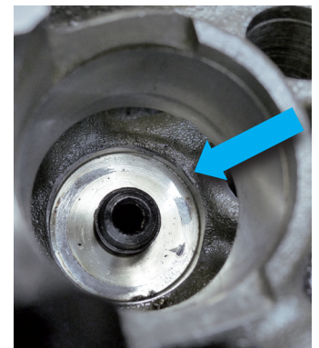
Рисунок 3: Следы неравномерной нагрузки в головке блока цилиндров
