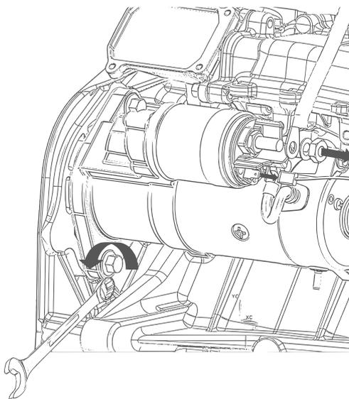
3.5 Убедитесь, что новый стартер аналогичен снятому стартеру. Сравните количество зубцов, тип фланца, электрические разъемы, номинальное напряжение, направление вращения и т.д.
