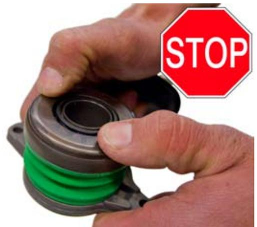
Een wankelend vliegwiel kan resulteren in lekkage van hydraulisch lager.
