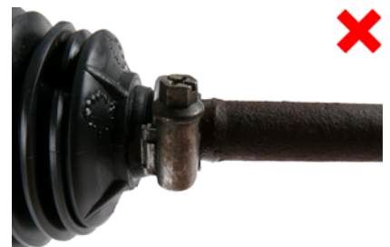
Fig.3: Zahnstange mit Korrosion / Gear rack with corrosion / Crémaillère avec corrosion / Cremallera con corrosión
