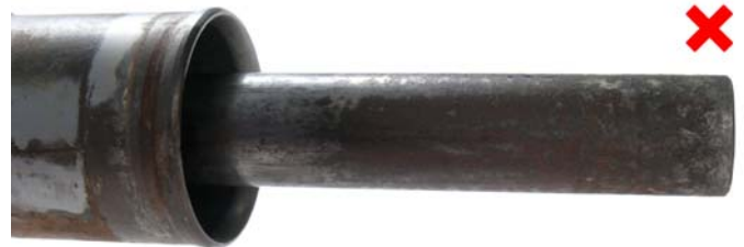
Fig.3: Zahnstange mit Korrosion / Gear rack with corrosion / Crémaillère avec corrosion / Cremallera con corrosión
