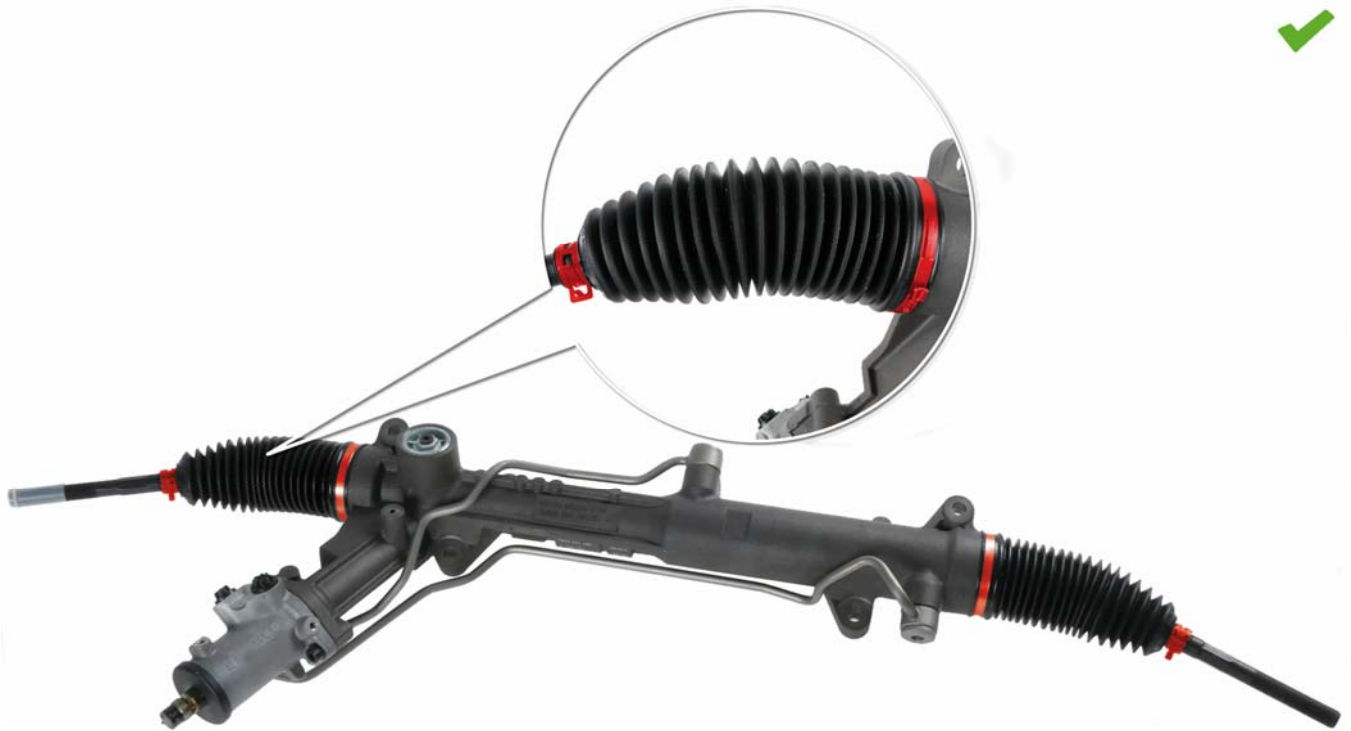
Fig.1: Lenkgetriebe mit korrekt montierten Lenkmanschetten / Steering box with correctly installed steering bellows / Crémaillère de direction avec soufflets de direction correctement montés / Caja de la dirección con manguitos de dirección correctamente montados
