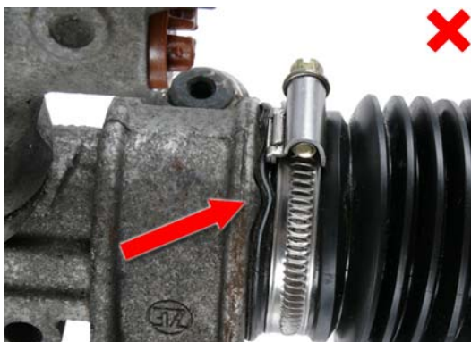
Fig.4/5/6: Bypass / Mangelhaft abgedichtete Lenkmanschetten./ Bypass - poorly sealed steering bellows./ By-pass / soufflets de direction / By-pass / Manguitos de dirección incorrectamente sellados.
