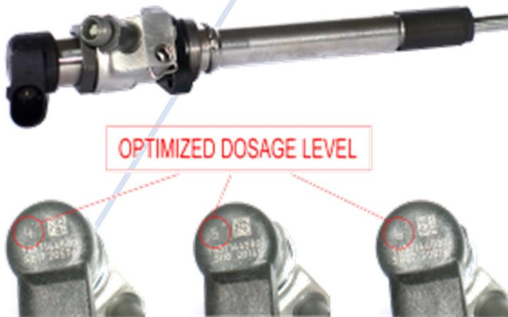
Los números rodeados en rojo indican el grado máximo de dosificación de combustible. Unos valores diferentes pueden causar descompensaciones e irregularidades en el funcionamiento del motor y en la gestión de los gases de escape.
