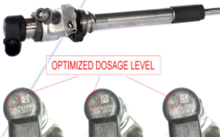
I numeri cerchiati in rosso identificano il grado di ottimale di dosaggio carburante. Differenti valori possono provocare scompensi ed irregolarità nel funzionamento motore e nella gestione dei gas di scarico.
