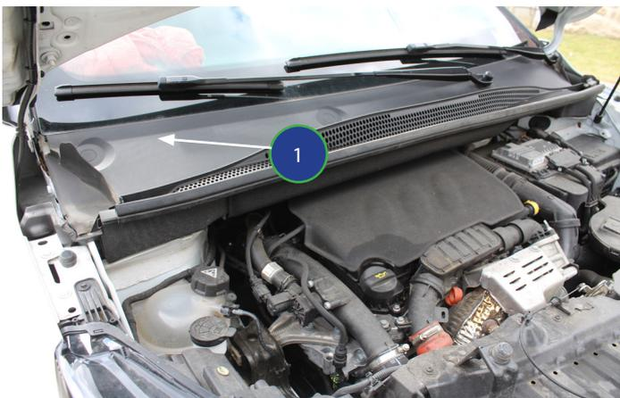
1. Le filtre d'habitacle est accessible sous le capot moteur, sous la baie de parebrise, coté passager (1).
