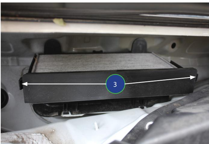
3. Ouvrir le boîtier filtrant en actionnant les deux loquets de fermeture à gauche et à droite (3). Basculer la trappe d'ouverture.
