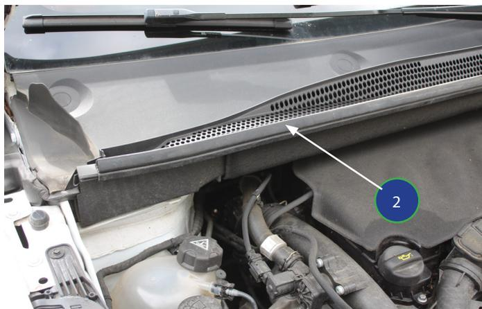
2. Retirer sur la moitié le joint d'étanchéité moteur(2) puis soulever la grille de ventilation. il n'est pas nécessaire de la retirer complètement.
