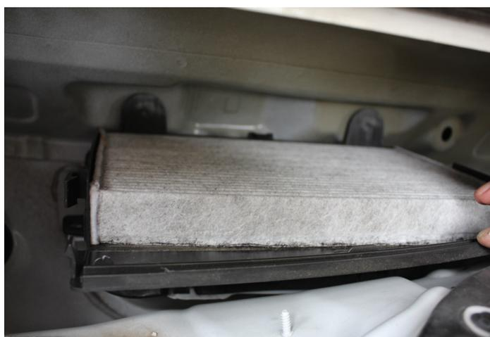
4. Extraire l'élément filtrant usagé et le remplacer. Le remontage s'effectue dans l'ordre inverse du démontage. Aucun outillage n'est nécessaire pour le remplacer.
