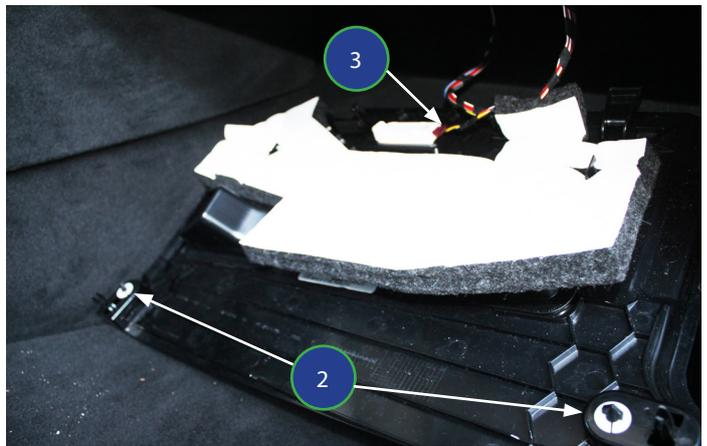
2. retirer le carter sous la boîte à gants en tournant d'un quart de tour les 2 fermoirs à droite et à gauche (2), une fois retiré débrancher le connecteur d'éclairage (3).
