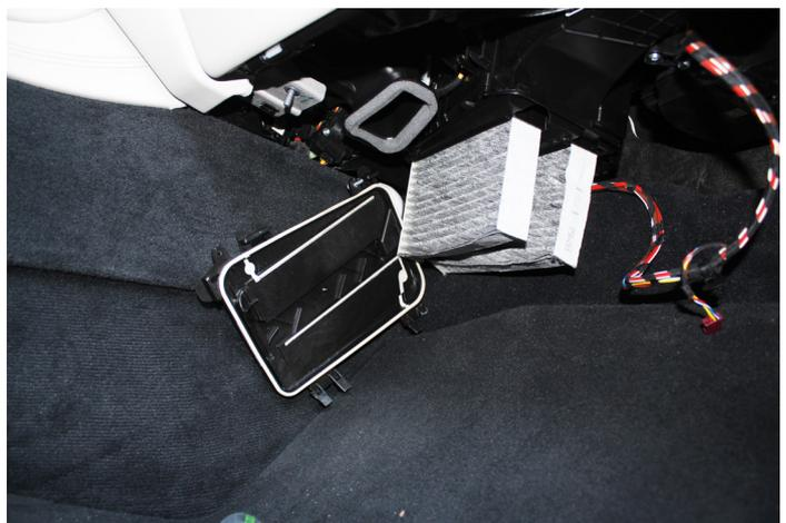
4. Sortir les éléments filtrant usagés et les remplacer. Le remontage s'effectue dans l'ordre inverse du démontage.
