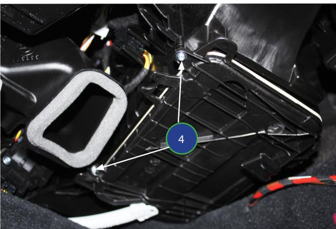
3. Ouvrir le boîtier filtrant en dévissant les 2 vis torx T25 (4) Ouvrir le boîtier et placer le couvercle sur le coté.
