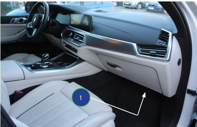
1. Les filtres d'habitacle sont situés à l'intérieur du véhicule, côté passager sous la boîte à gants (1).
