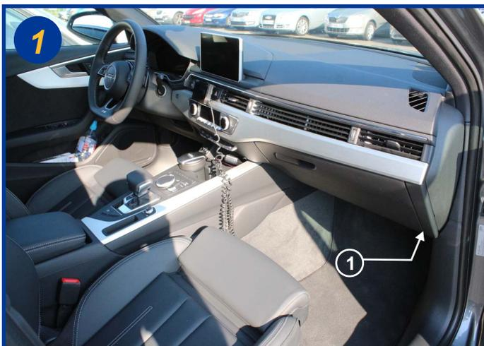
Le filtre d'habitacle est situé à l'intérieur du véhicule, côté passager sous la boîte à gants à droite (1).
