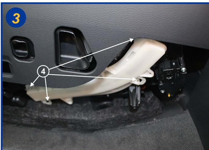
Ouvrir le boîtier filtrant à l'aide des pattes prévues à cet effet (4). Retirer le couvercle.
