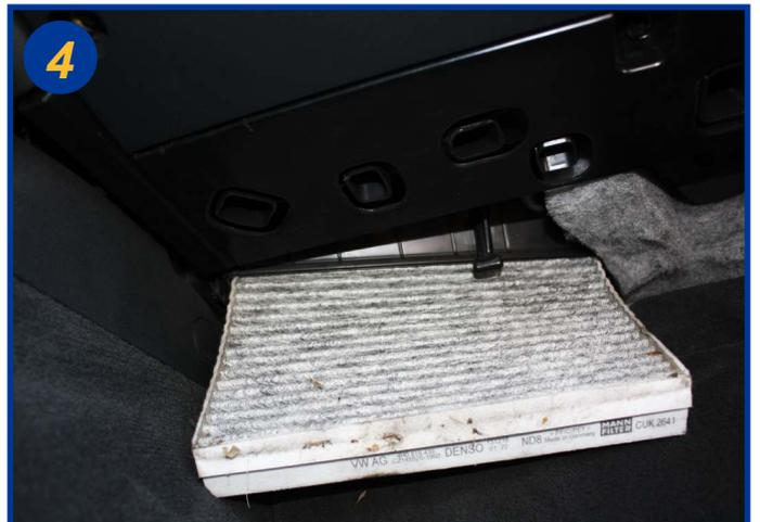
Extraire l'élément filtrant usagé et le remplacer. Le remontage s'effectue dans l'ordre inverse du démontage.
