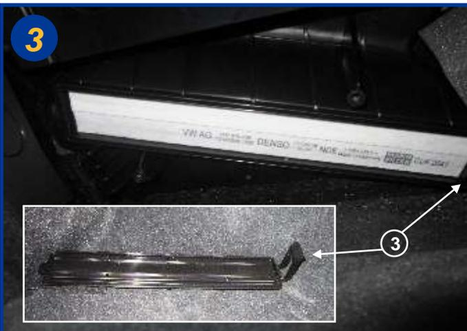
Ouvrir le boîtier filtrant par la droite (3) et retirer ce couvercle.
