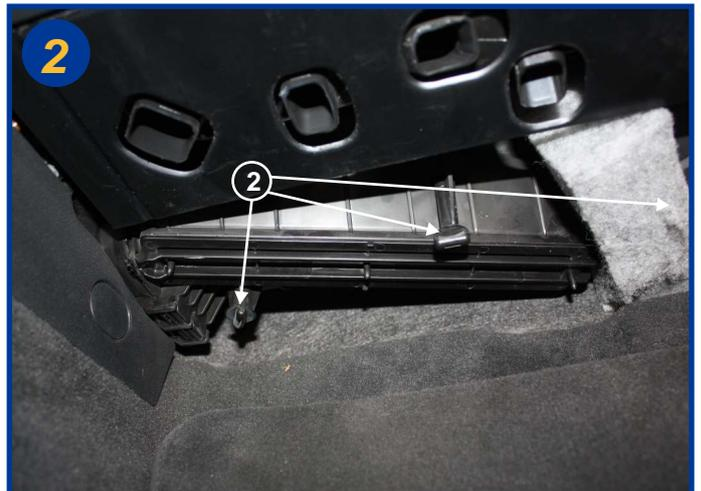
Démonter le carter souple maintenu par 3 vis papillons en plastique (2).
