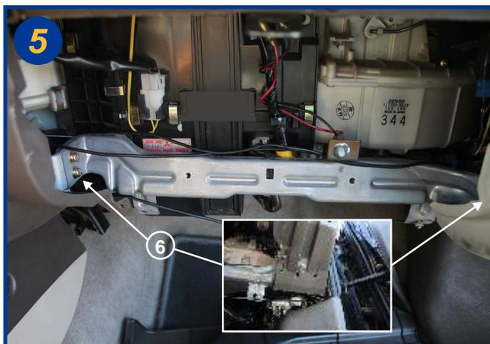
Dévisser ensuite les 3 vis cruciformes (6) 2 à gauche et 1 à droite (voir encadré) et retirer la traverse métallique.
