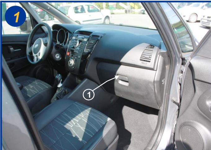
Le filtre d'habitacle est situé à l'intérieur du véhicule, côté passager dans la boîte à gants (1). Ouvrir la boîte à gants.
