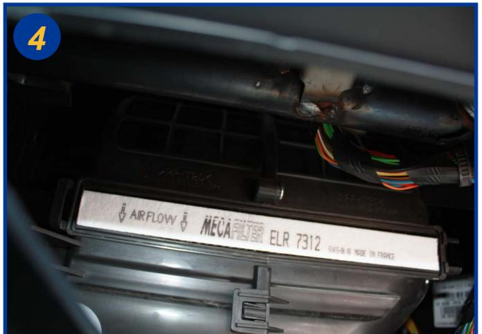
Procéder au remplacement du filtre. Le remontage s'effectue dans l'ordre inverse du démontage.
