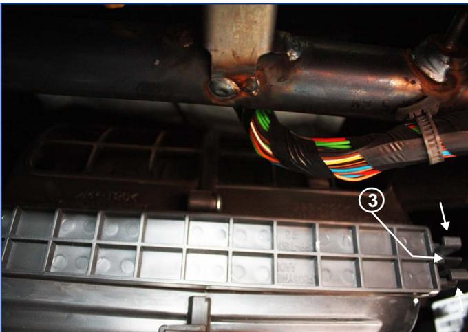
Ouvrir le boîtier filtrant (articulé sur la gauche) à l'aide de la poignée (3) dans le sens des flèches. Retirer le couvercle.
