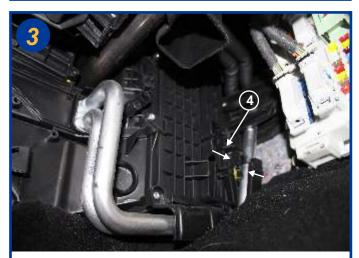
Ouvrir le boîtier filtrant en appuyant sur les 2 pattes du couvercle (4) dans le sens des flèches. Déposer le couvercle.
