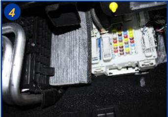
Sortir l'élément filtrant usagé et le remplacer. Reprendre les actions inversement pour le remontage.
