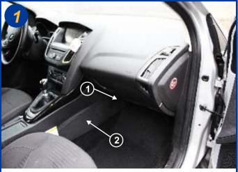
Le filtre d'habitacle est situé à l'intérieur du véhicule, coté passager, coté console centrale (1). Dégrafer le carter plastique (flanc de la console) en tirant fortement (2).
