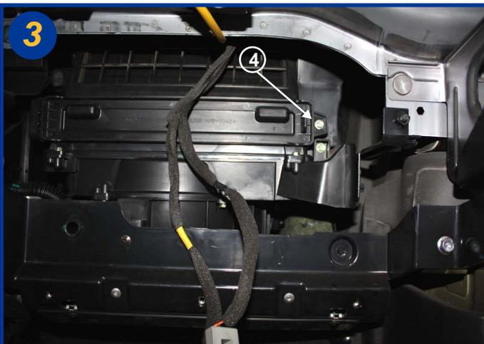
Le boîtier filtrant est alors devant vous, dévisser la vis cruciforme (4) pour retirer le couvercle.
