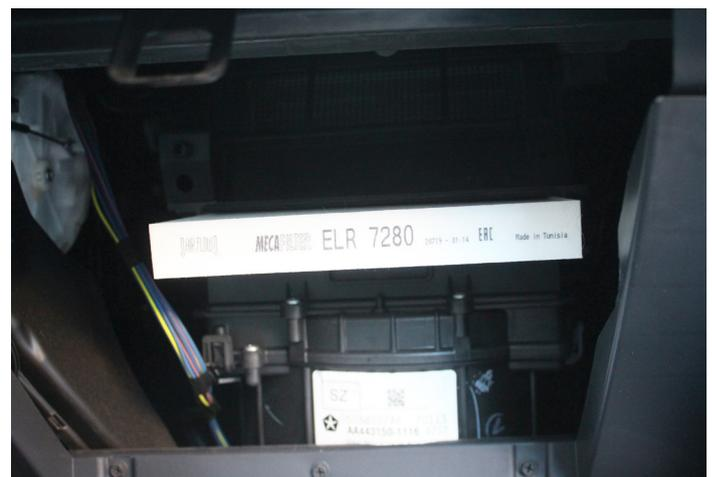
4. Sortir l'élément filtrant usagé et procéder à son remplacement. Le remontage s'effectue dans l'ordre inverse du démontage.
