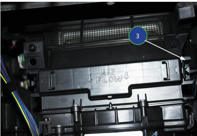
3. Ouvrir le boîtier filtrant en appuyant sur le loquet (3) et extraire le couvercle.
