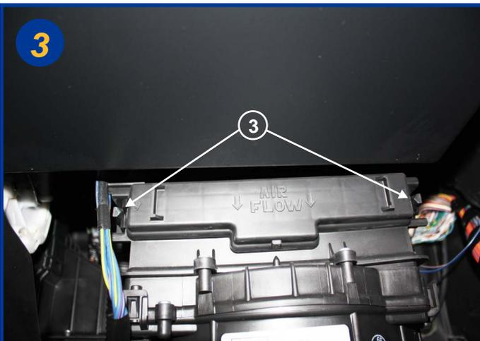
Appuyer sur les 2 ergots (3) et retirer le couvercle du boîtier filtrant.
