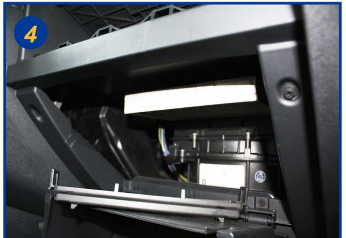
Extraire l'élément filtrant usagé et le remplacer. Le remontage s'effectue dans l'ordre inverse du démontage.
