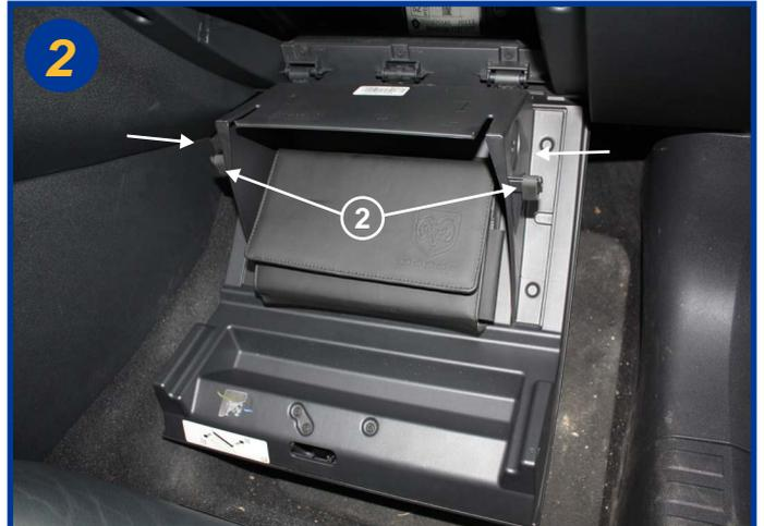
Ouvrir la boîte à gants, presser sur les flancs de côté pour dégager les arrêtoirs (2) et basculer le tiroir vers le bas.
