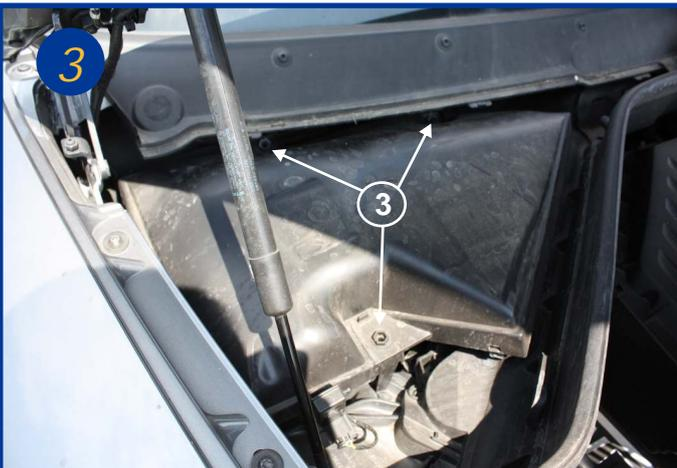
Dévisser également d'un quart de tour les 3 écrous plastiques (3) et soulever le boîtier filtrant. Il n'est pas nécessaire de débrancher l'indicateur de colmatage (4).
