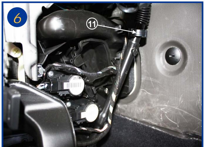
Ouvrir le collier (11) et mettre sur le coté la durite plastique et la connectique. Le boîtier filtrant est accessible.
