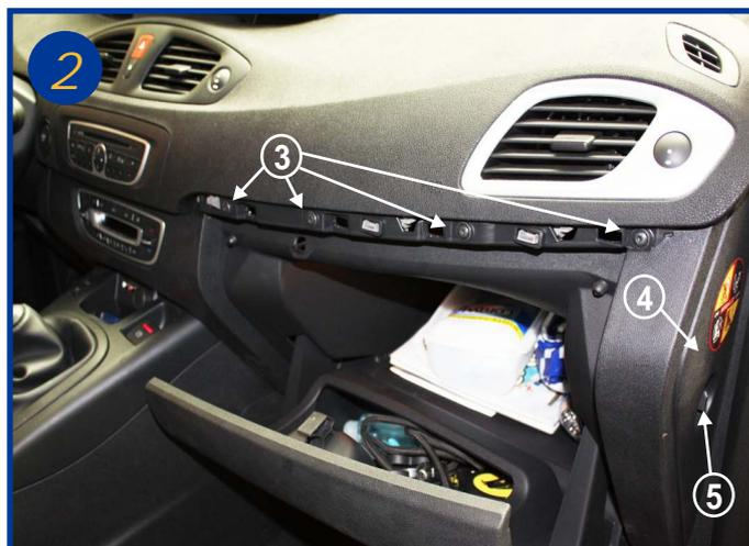
Dévisser les 4 vis torx (T20) (3). Dégrafer ensuite le flan (4) et déconnecter le bouton de désactivation de l'airbag (5).
