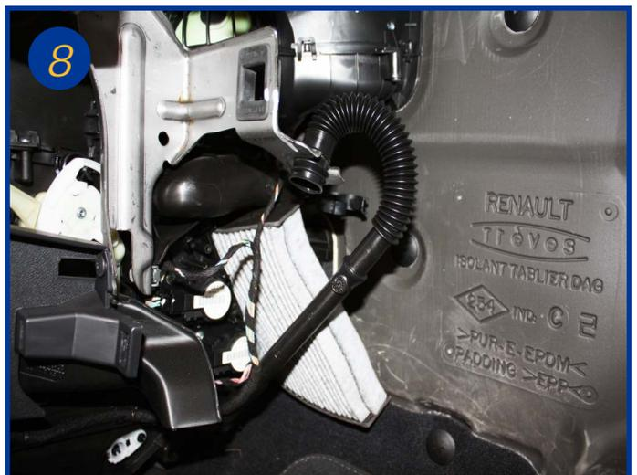
Extraire l'élément filtrant usagé en le déformant légèrement.
