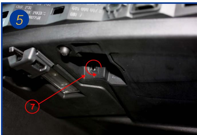
Dévisser la vis (7) à l'intérieur de la boîte à gants juste à côté du mécanisme de fermeture de la boîte
