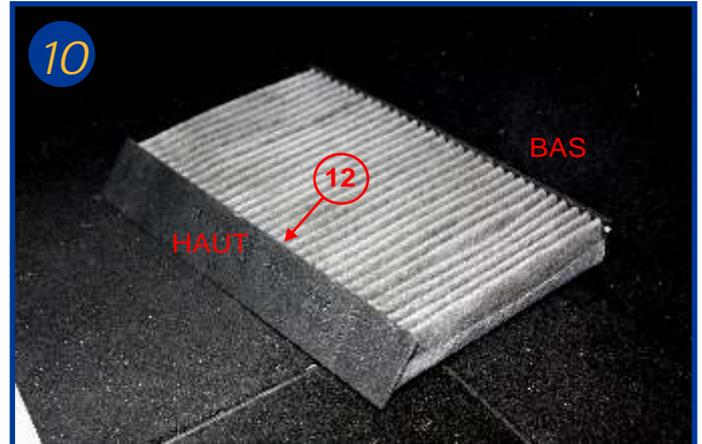
Replacer un filtre propre dans le boîtier en procédant de la même manière en mettant la partie inclinée (12) vers le haut du boîtier. Le remontage s'effectue dans l'ordre inverse du démontage.
