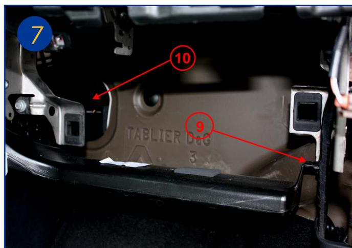
Déboîter et retirer le conduit de ventilation après avoir sorti le rivet plastique (9). Le boîtier du filtre se trouve dans le fond à gauche côté console (10).
