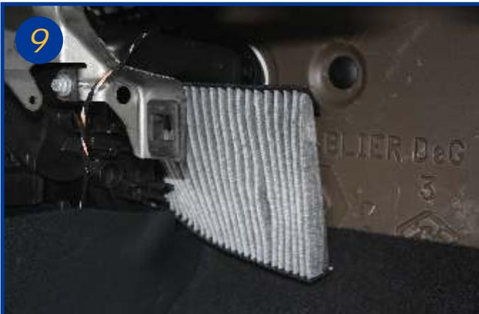
Vous pouvez alors sortir le filtre de son boîtier en le déformant, car l'ouverture est plus petite que la largeur de l'élément filtrant.
