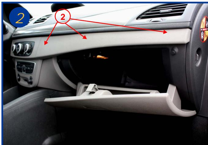
Ouvrir la boîte à gants et déclipser le bandeau supérieur du tableau de bord (2)
