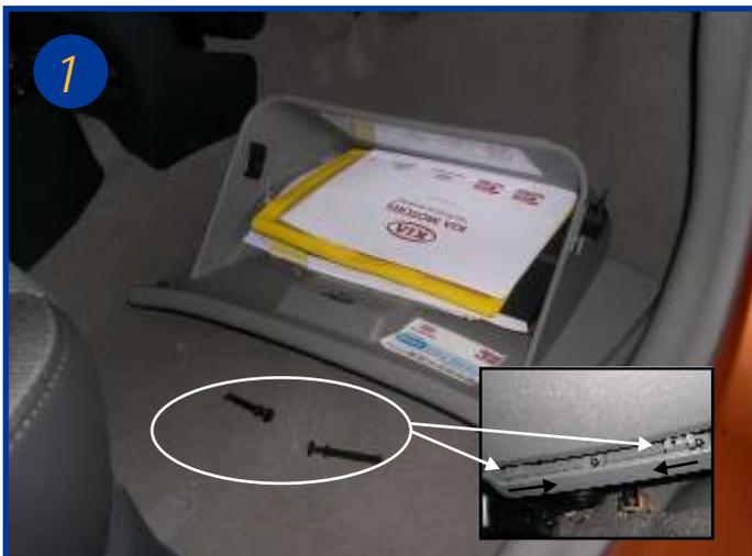
Le filtre d'habitacle est situé à l'intérieur, côté passager derrière la boîte à gants. 2 goupilles en matière plastique sont à retirer (repère 1) pour retirer la boîte à gants
