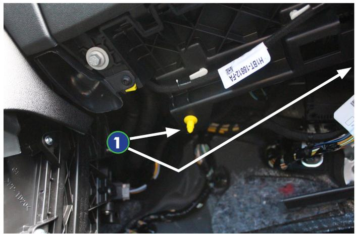
1. Le filtre d'habitacle est situé à l'intérieur du véhicule, côté passager, côté console centrale. Dévisser la vis située sur le flanc de la console après avoir retiré le petit cache en plastique (voir encadré).
