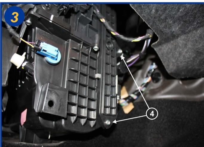
Dévisser ensuite les 2 vis torx (T20) (4) et ouvrir la trappe du boîtier filtrant. Retirer cette trappe.
