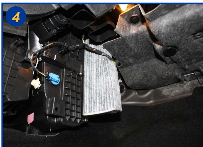
Extraire le filtre usagé de son logement en le déformant. Procéder à son remplacement. Le remontage s'effectue dans l'ordre inverse du démontage.
