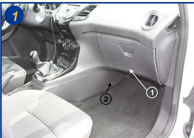
Le filtre d'habitacle est situé à l'intérieur du véhicule, côté passager sous la boîte à gants, côté console (1). Retirer le clips plastique (2).
