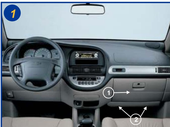
Les filtres d'habitacle sont situés à l'intérieur du véhicule coté passager derrière la boîte à gants (1). Dévisser les 2 vis cruciformes (2) et retirer la garniture sous la boîte à gants.
