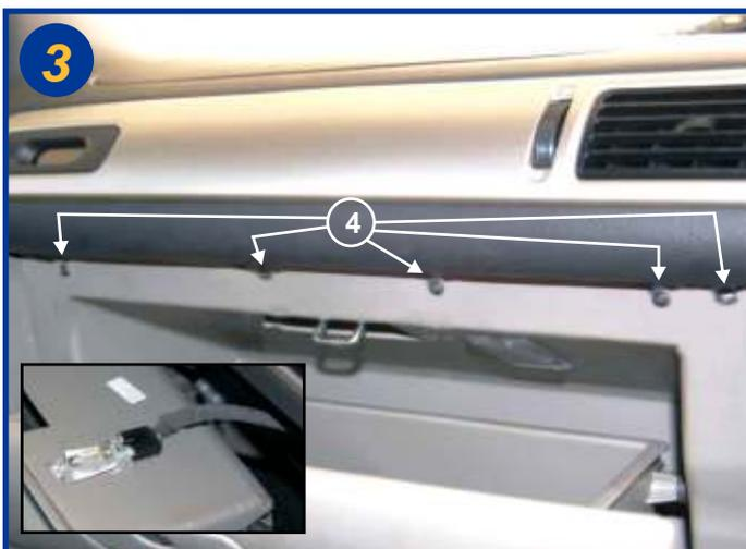
Ouvrir la boîte à gants et dévisser les 5 vis cruciformes (4) situées sur la partie supérieure et retirer entièrement la boîte à gants tout en ayant débranché la connectique de l'éclairage de boîte (voir encadré).
