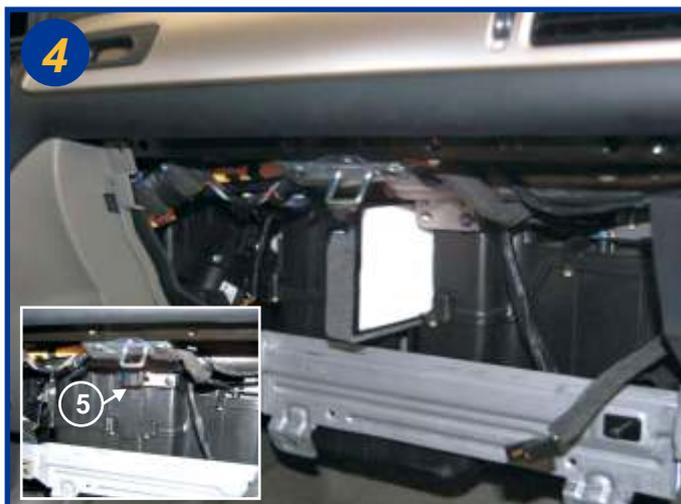
Dé-encliqueter le couvercle du boîtier filtrant (5) (voir encadré). Extraire l'un après l'autre les filtres usagés et les remplacer. Le remontage s'effectue dans l'ordre inverse du démontage.
